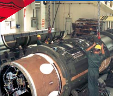
Missile en cours de démantèlement
